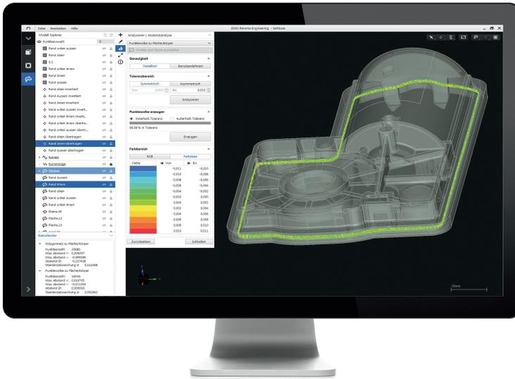
**Virtuelle Anpassungen:** Nach der Korrektur des Werkzeugs mit ZRE liegen die überarbeiteten Flächen des Bauteils im grünen Bereich. (© Zeiss)
